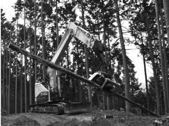
写真-3 プロセッサによる造材
