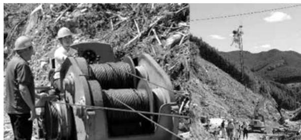
写真-2 大型ウインチによる架線集材
