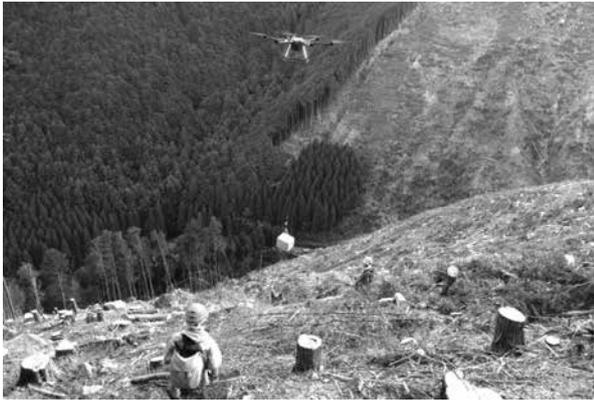
写真-6 資材を運搬する大型ドローン
