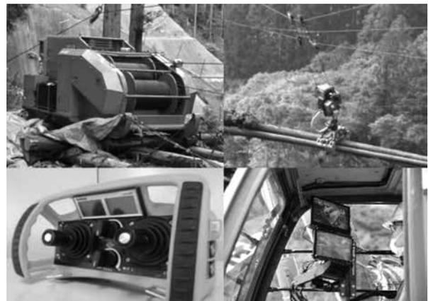
写真-5 遠隔操作式架線集材システム
